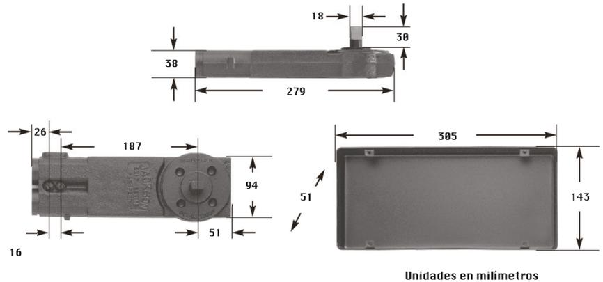
Únicamente se garantiza la bisagra al estar instalada con todos sus accesorios incluidos y completamente alineado el spindle de la bisagra con su pivote
