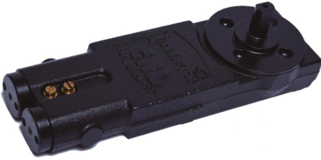
La bisagra de piso Jackson modelo 330 es ideal para puertas de aluminio, madera, acero vaciado y cristal templado, cuenta con una capacidad de 118 Kg y es recomendada para puertas en exterior hasta .914m y en el interior hasta 1.067m. La capacidad de la bisagra es de 500,000 ciclos, con un año de garantía.
